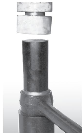
6. Retire los tornillos del buje bar pin tipo cónico , y apoye el extremo de la barra de torsión en la herramienta de recepción con el perno cónico hacia abajo y el tubo extremo centrado en la herramienta. Asegúrese de que la barra de torsión esté apoyada perpendicularmente en la cama de la prensa para mayor seguridad.
