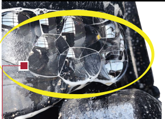
FIGURA 2 CÁMARA DE AIRE CON FUGAS
