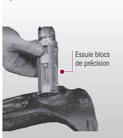
FIGURE 9 Porte-fusée de direction supérieur montré
