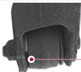
Bride de caoutchouc manquante
