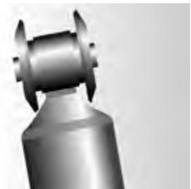
Ejemplo de instalación inadecuada: rondanas instaladas al revés (si está equipado)
