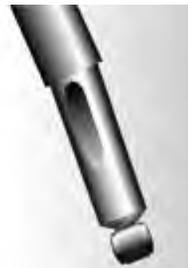
Amortiguador doblado o abollado
