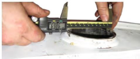
El diámetro interno del orificio central de la viga igualadora de la nueva ULTIMAAX es  $3.886" \pm 0.003"$  ( $98.7 \text{ mm} \pm 0.1 \text{ mm}$ )
