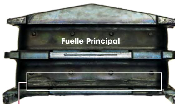
**Apariencia abrillantada** — Los pliegues formados en la superficie del hule bajo carga son aceptables.
