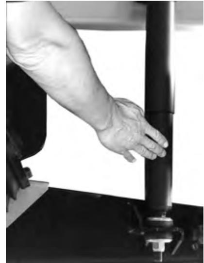
3. Para inspeccionar una falla interna, retire y agite el amortiguador que se sospecha. Escuche el sonido de las partes metálicas haciendo ruido dentro. El ruido de las partes metálicas puede indicar que el amortiguador tiene una falla interna y el amortiguador debe ser reemplazado.
