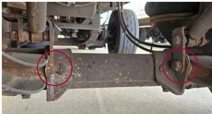
FIGURE 9-1 : CONNEXIONS DE PIVOT : USURE DES RONDELLES BLANCHES
