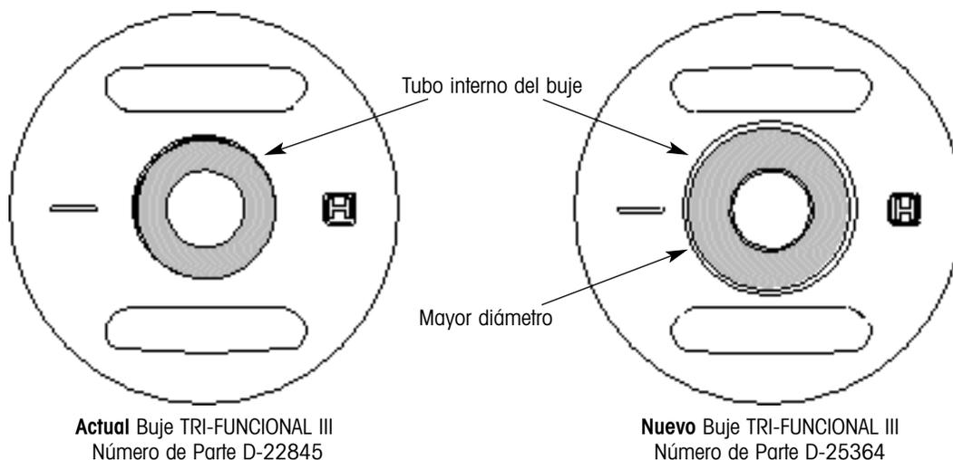
También incrementamos la firmeza de los nuevos bujes TRI-FUNCIONALES III, haciéndolos más resistentes que los bujes actuales. Si se utilizan los bujes nuevos y actuales en el mismo eje, su desgaste será irregular por el incremento de firmeza y durabilidad de los nuevos bujes. Por lo tanto, **los bujes nuevos y actuales TRI-FUNCIONALES III no deben ser utilizados en el mismo eje. Los nuevos bujes TRI-FUNCIONALES III deben ser instalados en ambas conexiones pivote de la suspensión.**
