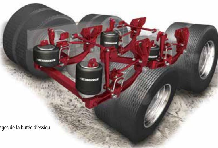
1. La course de l'essieu peut être limitée par le constructeur du véhicule; les réglages de la butée d'essieu peuvent restreindre l'articulation de la suspension.
