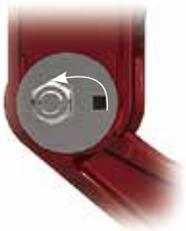
QUIK-ALIGN® — La rotation du collier excentrique permet un alignement des essieux jusqu'à 1 pouce de chaque côté
