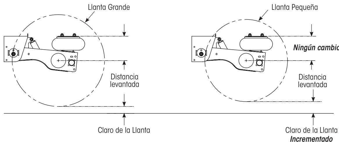
Reducir el tamaño de la llanta también aumentará la altura de manejo de la suspensión cuando se baje el eje. Exceder la altura máxima permitida de manejo podría provocar una pérdida de la capacidad de suspensión y daños a los componentes de la suspensión. Nunca se debe exceder la altura de manejo máxima permitida de la suspensión. Consulte la literatura L388SP Especificaciones de Altura de Manejo Recomendadas para determinar la altura máxima de manejo.
