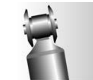
Ejemplo de instalación inadecuada: rondanas instaladas al revés (si están equipadas)
