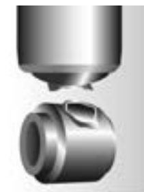
Soporte inferior o superior dañados
