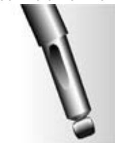
Amortiguador doblado o abollado
